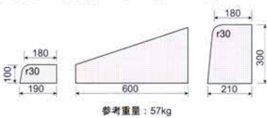
(C-3) 片面歩車道C1段切下げ（BC用フラット）
